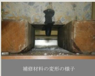
補修材料の変形の様子
