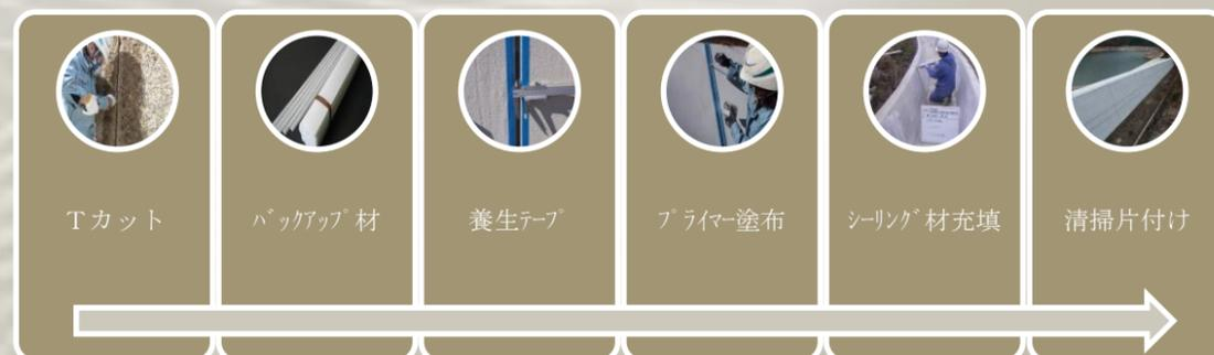
※ ひび割れ工のバックアップ材は貫通ひび割れ及びひび割れ深さがTカットのビット規格値（深さB）より深い場合に採用する。
