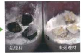
抗菌操作試験状況 強制的に腐朽菌を繁殖させた培地上に12週間過酷な条件下に放置
